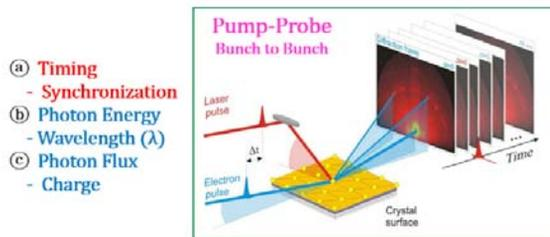
Figure 3: Important parameter on the Pump-Probe.
